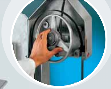
1 - Sistema brevettato estrazione e supporto puleggia Patented pulley support removing system
