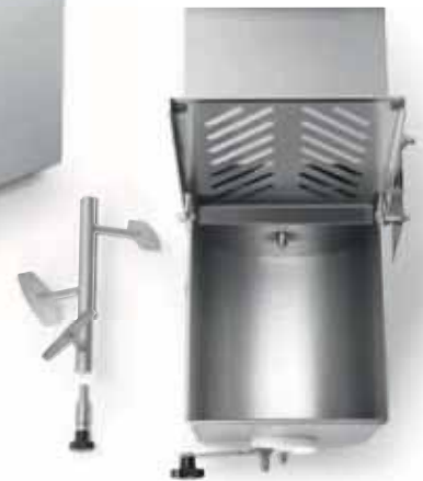
3 - Pala facilmente rimovibile Removable mixing arm
