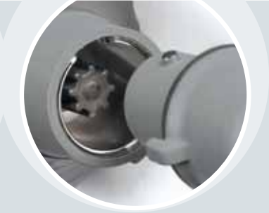
4 - Attacco rapido utensili Shaft release system
