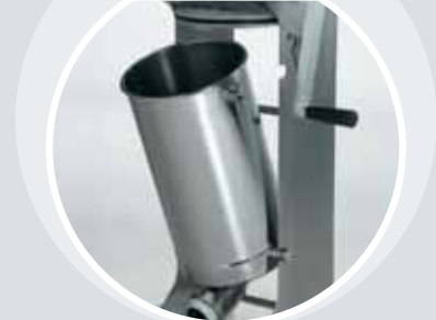
1 - Cilindro caricabile direttamente dalla macchina Cylinder fillable directly from the machine
